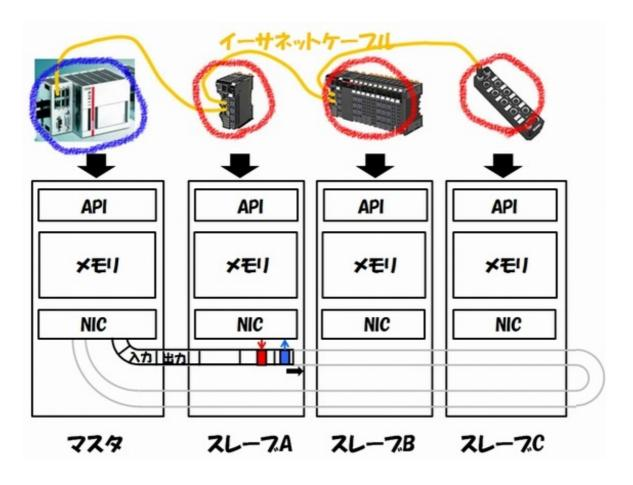
違いといえば、APIの上で動くアプリケーションが、エクセルやワードではなく、マスタ用の制御プログラム、スレーブが動かす介助ロボット、各種センサーであるところです。
